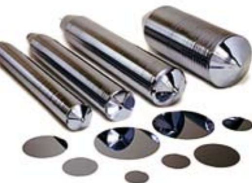
Metodą Czochralskiego wytwarza się dziś bryły krzemu, które są gigantycznymi kryształami. Z nich robione są diody, tranzystory i układy scalone.
